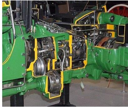
Otra vista de la caja de velocidades y la parte posterior a la que se le llama propiamente sistema de transmisión.
