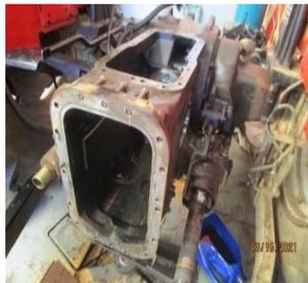
Vista de la caja de un sistema de transmisión en reparación, observar que, de acuerdo al diseño, se le transfiere tracción a las ruedas delanteras, mediante la flecha que observa al margen derecho, lo que indica que es 4 x 4.
