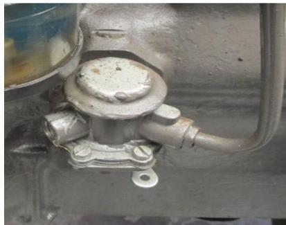
**Bomba de inyección de cuatro pistones y cuatro inyectores:** Se encarga de procesar el combustible diésel e impulsarlo a los inyectores, mediante tubería.
