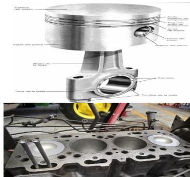
Vista de un motor de combustión interna a cuatro tiempos, se observan los cuatro pistones y las camisas, es por donde hacen su recorrido y tubería por donde se conduce el diésel.
