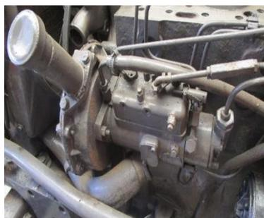
**Inyectores, varillas, tapa de punterías, tornillos, tuercas y rondanas:** Son las estructuras encargadas de aplicar una parte del combustible y que se mezcle con 15 partes de aire por una de combustible, para que se lleve a cabo la explosión y esto hace que el pistón baje necesariamente con fuerza.
