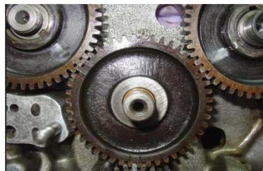
**Árbol de levas con engrane:** Estructura que gira mediante bujes y un engrane lo hace girar mediante las bases de o buzos, estos impulsan a las varillas que suben y bajan, y a la vez las varillas accionan los balancines y estos determinan que se abran o se cierren las válvulas de admisión y de escape.
