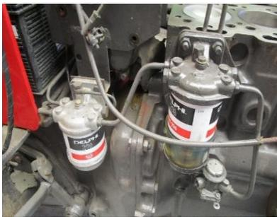
**Bomba de elevación:** Se encarga de impulsar el diésel, hacia la bomba de inyección
