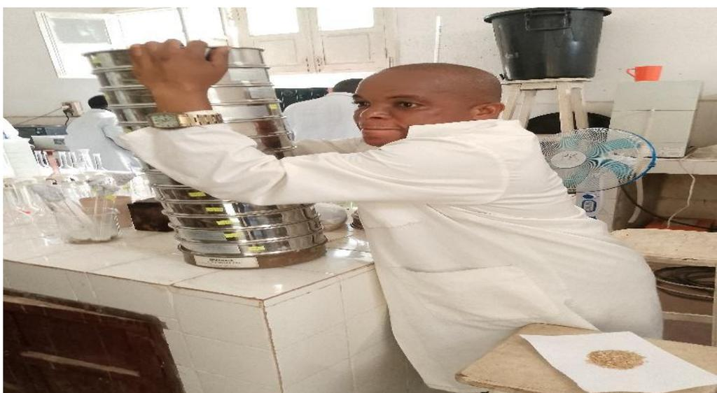
Figure 3 : Analyse granulométrique manuelle au laboratoire
