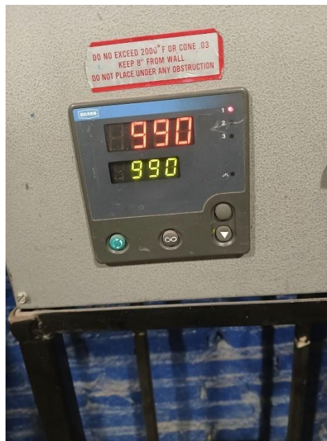
Figura 4. Horno de tratamientos térmicos
